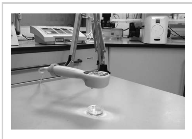
Рис. 1. Расположение лазерной излучающей головки относительно чашки с культурой клетки МСК.
