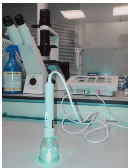
Рис. 2. Расположение лазерных излучающих головок относительно чашки с культурой клетки МСК
