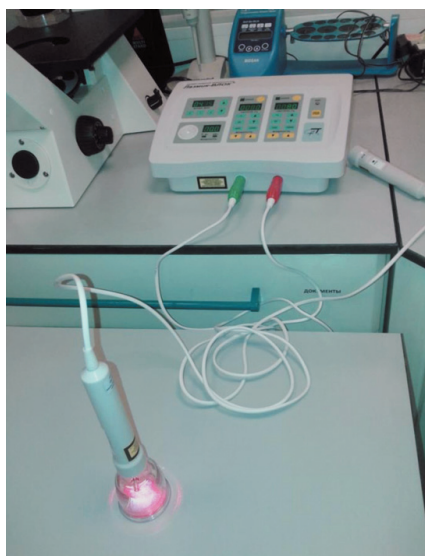
Рис. 2. Расположение лазерных излучающих головок относительно чашки с культурой клетки МСК
